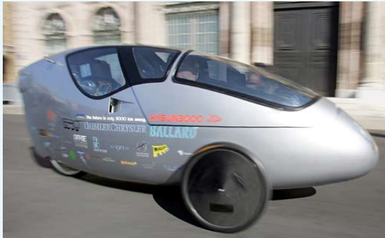
Et team med mer enn tretti tyske ingeniører deltok i byggingen av HySun3000, et kjøretøy som i 2004 tilbakela tre tusen kilometer på europeiske veier med bare tre kilo hydrogen som drivstoff. Kilde: Boris Horvat / SCANPIX
